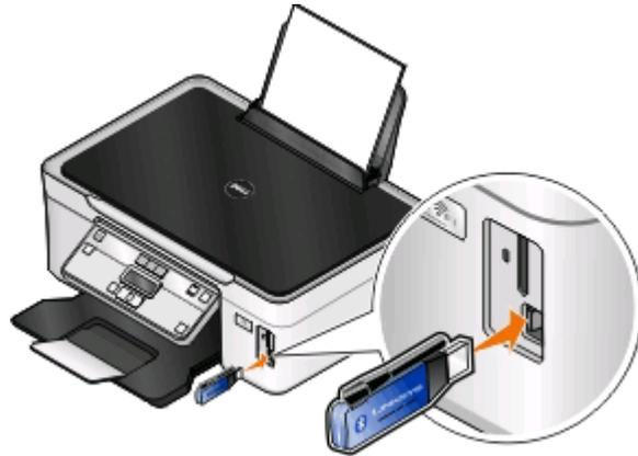
**Bluetooth-Dongle** angeschl. wird im Display angezeigt.
