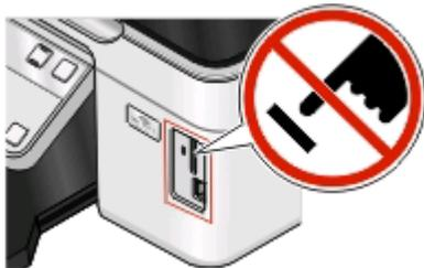
**Warnung - Mögliche Schäden:** USB-Kabel, Netzwerkadapter, Anschlüsse, Speichermedium oder Drucker sollten im angezeigten Bereich während eines Druck-, Lese- oder Schreibvorgangs mittels Speichermedium nicht berührt werden. Daten können verloren gehen.
