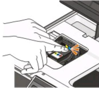
**Hinweis:** Setzen Sie die neuen Tintenpatronen direkt nach dem Entfernen der Schutzkappe ein, damit keine Luft in die Patrone gelangt.
