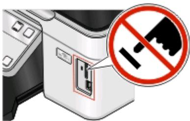
**Warnung - Mögliche Schäden:** Kabel, Netzwerkadapter, Anschlüsse, Speichermedium oder Drucker sollten im angezeigten Bereich während eines Druck-, Lese- oder Schreibvorgangs mittels Speichermedium nicht berührt werden. Daten können verloren gehen.
